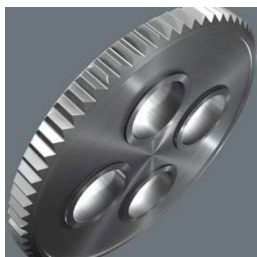
Zyklop Metal Switch Dwukierunkowe grzechotki posiadają drobną podziałkę z 72 zębami zapewniającą niewielki kąt pracy wynoszący zaledwie 5°. Niewielki skok pozwala na szybką i dokładną pracę w różnych przestrzeniach montażowych.
