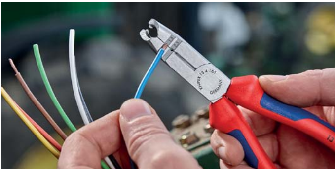
Profile do ściągania izolacji z przewodów o przekroju 1,5 i 2,5 mm 2
