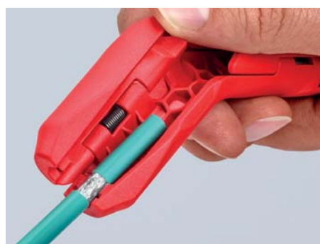
Usuwanie izolacji z przewodu teleinformatycznego
