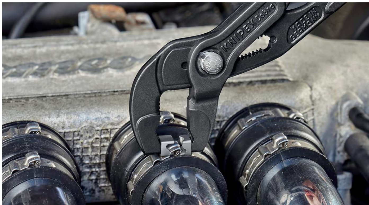
Otwieranie opaski zaciskowej bez ogranicznika
