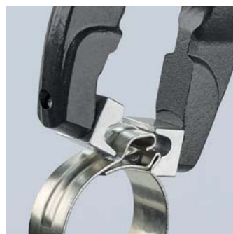
Otwieranie opaski zaciskowej bez ogranicznika
