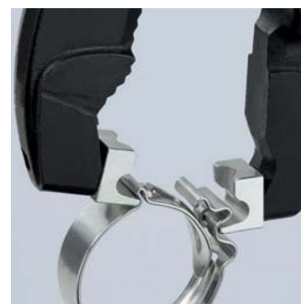
Zaciskanie opaski zaciskowej z ogranicznikiem
