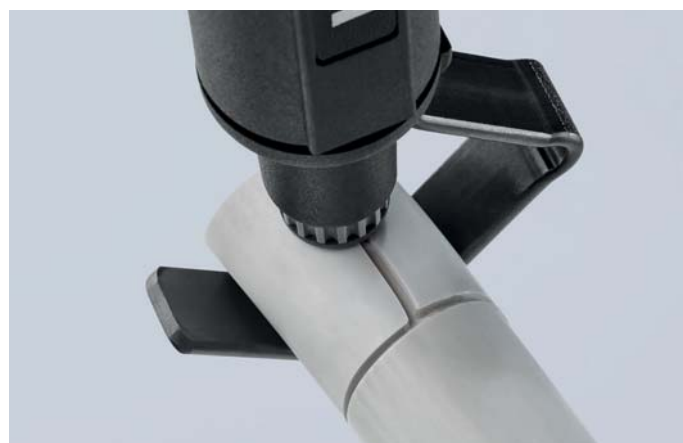
Obrotowy element obejmujący do cięcia wzdłużnego
