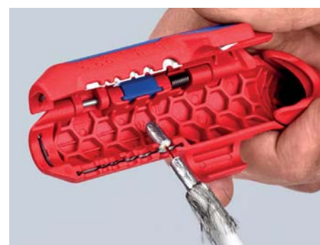
Usuwanie izolacji z przewodów koncentrycznych
