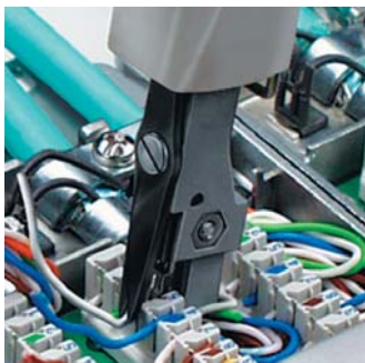
Wciskanie i odcinanie przewodu w jednej operacji
