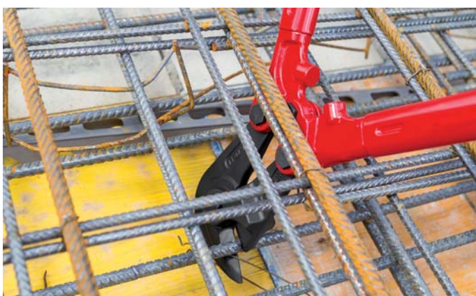
Specjalny kształt główki przecinaka do mat 71 82 950 umożliwia cięcie płasko leżącej stali budowlanej
