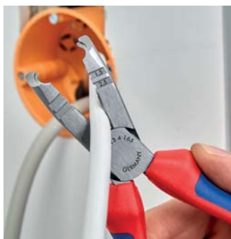
Do cięcia kabli o średnicy do Ø 13 mm
