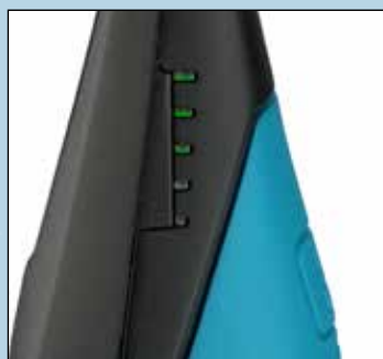
Diody LED ładowania i poziomu naładowania, 5 poziomów
